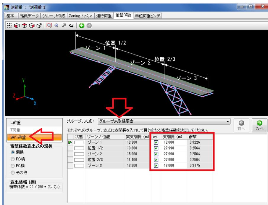
図 11: 線荷重 P による部材の衝撃係数
