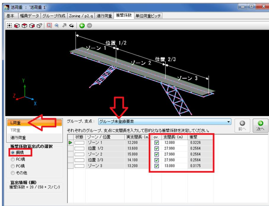
図 9: 等分布荷重 q による部材の衝撃係数
