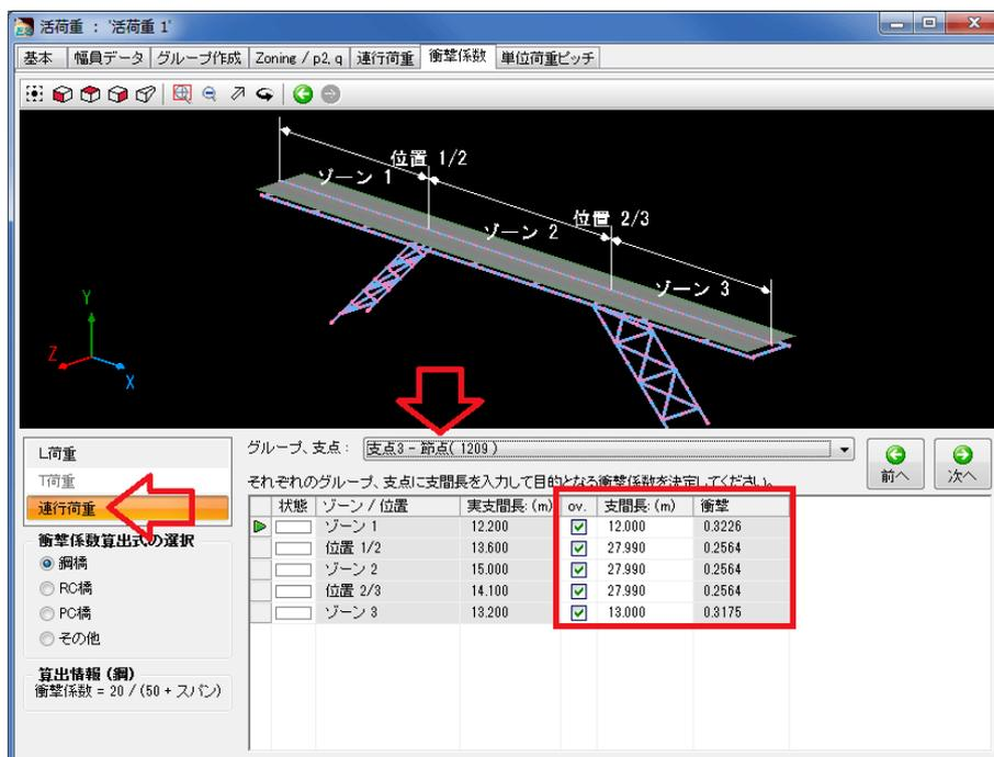
図 12: 線荷重 P による支点の衝撃係数
