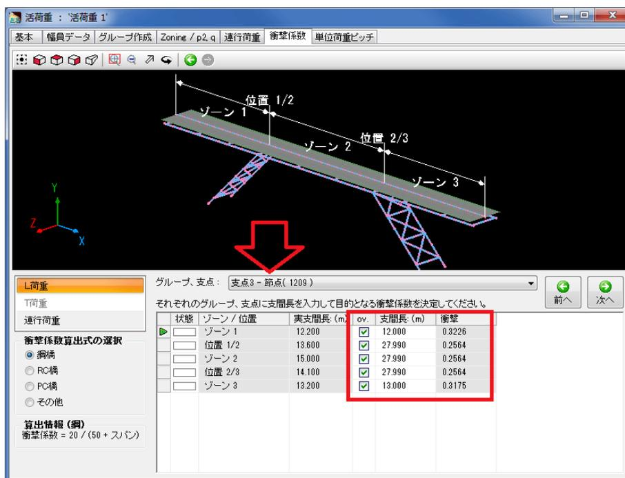
図 10: 等分布荷重 q による支点の衝撃係数
