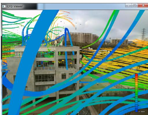
図16. 流線による表示(風の流線の線)
