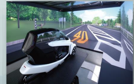
車両性能実証装置 高精度ドライビング・シミュレータ
