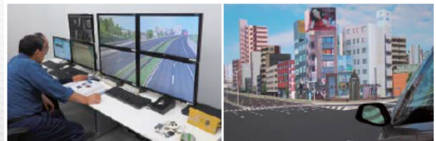
■ ドライビング・シミュレータのコントロールルーム (左) UC-win/Roadでリアルに再現された名古屋の街並み (右)
