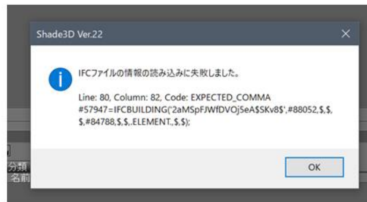
破損IFCファイルのエラー箇所、内容表示
