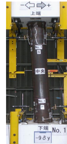
上部引張側状況 完全に鋼管が割れ、内部コンクリートが見えている。
