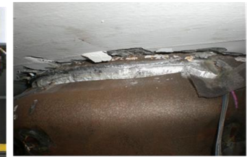
上部引張側状況 完全に鋼管が割れ、内部コンクリートが見えている。
