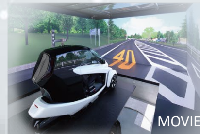
車両性能実証装置 高精度ドライビング・シミュレータ
