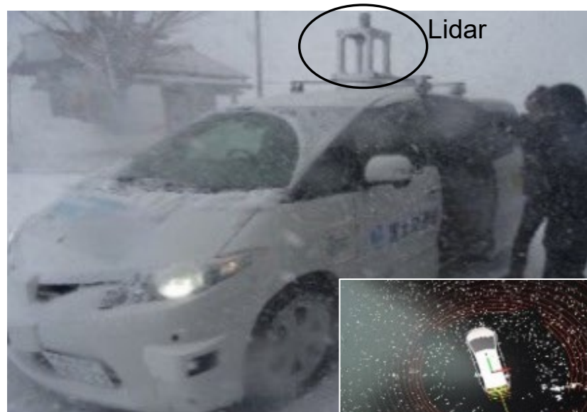
※白い点は車両が障害物と認知した物体 (雪を誤検知)
