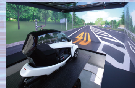
車両性能実証装置 高精度ドライビング・シミュレータ
